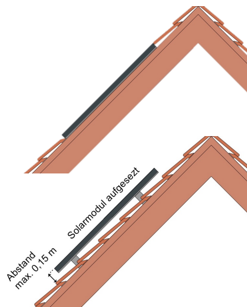
Solar modul integriert und aufgesetzt, unmaßstäblich, eigene Darstellung
